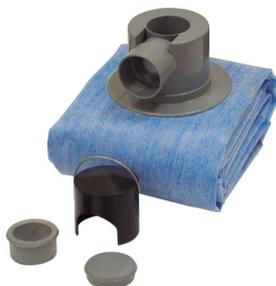
El **kit imperband** standard es un sistema de impermeabilización de interiores formado por un sumidero de ABS termosoldado a una lámina impermeable de 150 x 225 cm. Especialmente recomendado para la impermeabilización de platos de ducha en proyectos de obra nueva. Uso residencial.
